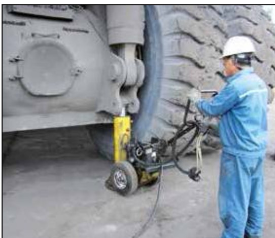
◀ Pow'r-Riser® al Enerpac folosit în operații miniere pentru a ridica echipamente grele.
