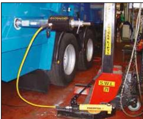
◀ Un cilindru RACH-306 acționat de pompă manuală P-392 este folosit pentru extragerea bolțurilor corodate ale unui vehicul.
